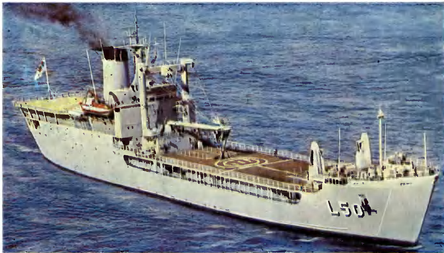
АВСТРАЛИЙСКИЙ ТАНКОДЕСАНТНЫЙ КОРАБЛЬ L50 „ТОБРУК“. Его полное водоизмещение 5800 т, длина 127 м, ширина 18,3 м, осадка 4,9 м, мощность энергетической установки 9600 л. с., скорость полного хода 17 уз, вооружение — две 40-мм артиллерийские установки. Десантовместимость: до 500 десантников, 1300 т груза, десантные катера (по два LCM-8 и LCVP). Принимает на борт три вертолета „Уэссекс-31В“.
